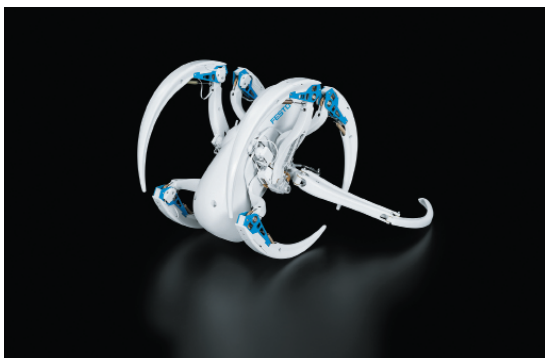
РИС. 2. ▼ BionicWheelBot: режим кувыркания
