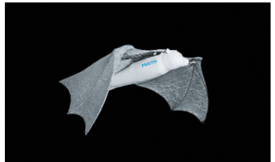
Рис. 4. ▼ Крылья BionicFlyingFox покрыты специальной мембраной
