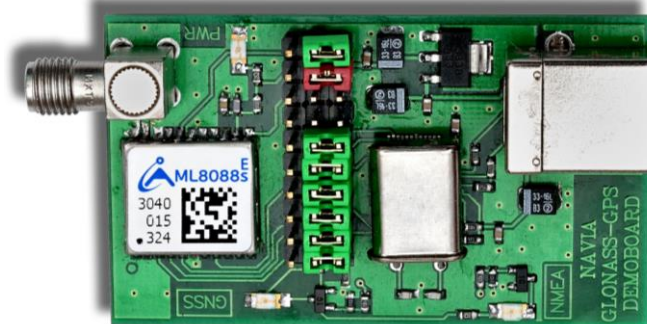
Рис. 4. Внешний вид малогабаритной демонстрационной платы для приемника ML8088sE (не в масштабе 1:1).
