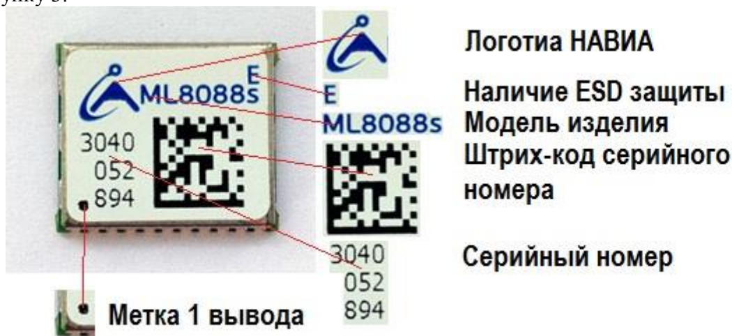
Рис. 3. Этикетка приемника навигационного ML8088sE, элементы
