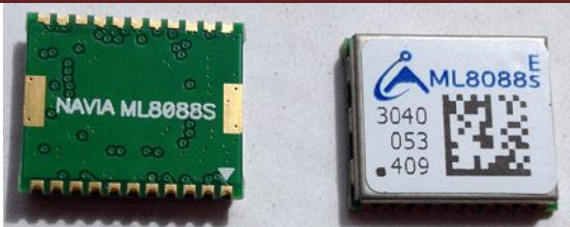
Рис. 2. Внешний вид приемника навигационного ML8088sE (не в масштабе 1:1)
