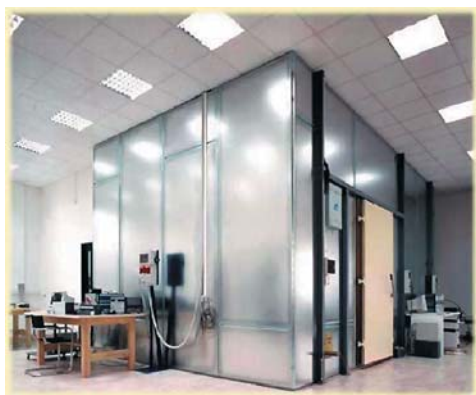
Рис. 1. Экранированное пространство в виде клетки Фарадея
