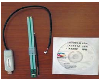
Рис. 8. Отладочный набор для тестирования схем сбора данных с датчиков линейного перемещения
