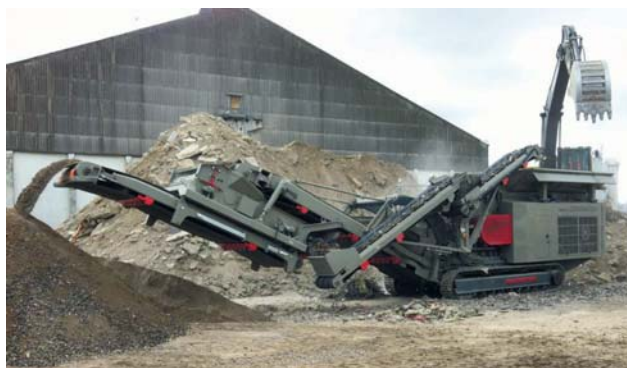
Рис. 7. Параллельная гибридная камнедробилка ROCKSTER
