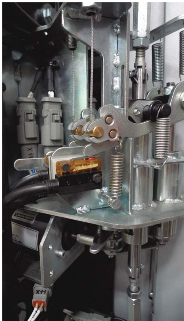
Рис. 1. Применение микропереключателей S970 в приводах дверей на подвижном составе
