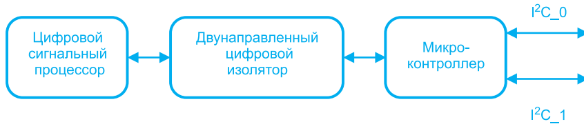
Рис. 8. Структурная схема работы последовательного интерфейса конвертера GP100H3M54TEZ под управлением цифрового сигнального процессора (DSP)
