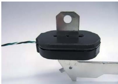
● Рис. 4. Датчик тока Pulse, приспособленный для плоской шины
