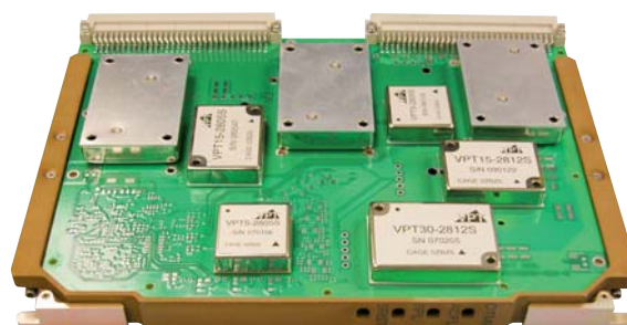
Рис. 5. Модуль блока питания, разработанный в стандарте VPE на базе серийно выпускаемых модулей VPT
