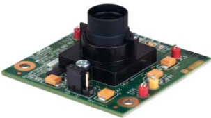
Рис. 3. Плата датчика изображений Panasonic MN34041 с датчиком HDR-60 — типичный пример устройства с интерфейсом SubLVDS, которое можно подключить к макетной плате типового видеомоста с интерфейсом USB3 компании Lattice (иллюстрация предоставлена компанией Panasonic)
