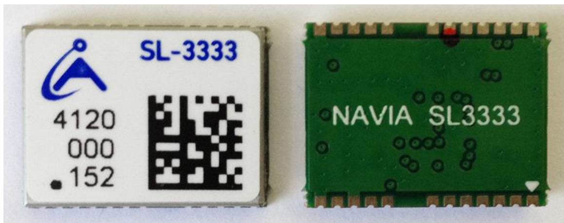
Рис. 3. Внешний вид приемника SL3333 сверху и снизу (не в масштабе 1:1).
