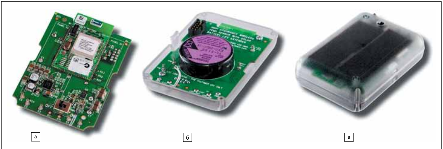
Рис. 2. ИС LTC3330: а) передняя часть платы, на которой находится сигнальная цепь, а также цепи питания, управления и беспроводной модуль; б) батарея на задней части платы; в) полное решение в корпусе с установленной солнечной панелью
