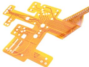
Рис. 2. Образец многослойной гибкой печатной платы (FPC) с паяными и разъемными соединениями
