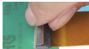
Рис. 6. FFC/FPC-разъем с фронтальной поворотной защелкой шлейфа
