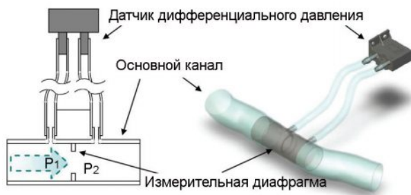
Рис. 2. Типовая схема применения датчика дифференциального давления
