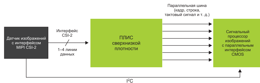
Рис. 3. Мост для датчика изображений с интерфейсом CSI-2 на базе ПЛИС сверхнизкой плотности
