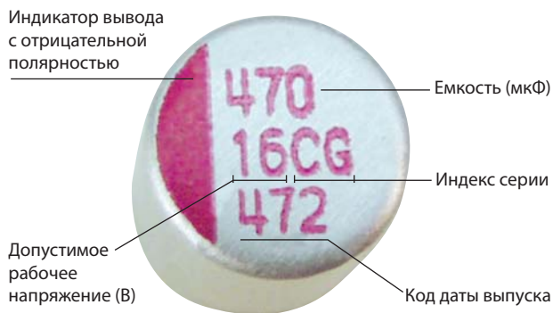
Рис. 15. Маркировка полимерных конденсаторов
