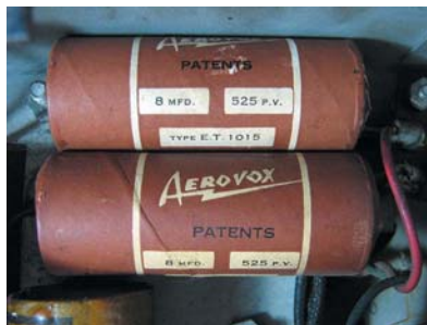
Рис. 2. Два электролитических конденсатора 1930-х годов (8 мкФ, 525 В) (источник: Ozguy89, English language Wikipedia)
